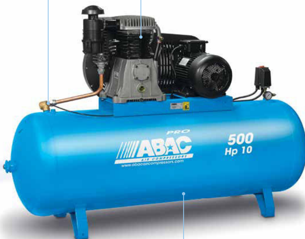
PRO B7000 500 FT 10 10 hp, 500 litres, 15 bar
